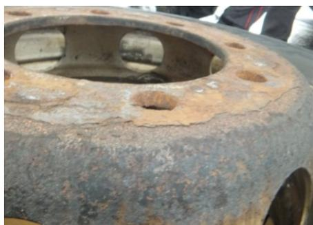
ディスク・ホイールのボルト穴や、ホイールの当たり面に、著しいさびによる劣化や損傷
