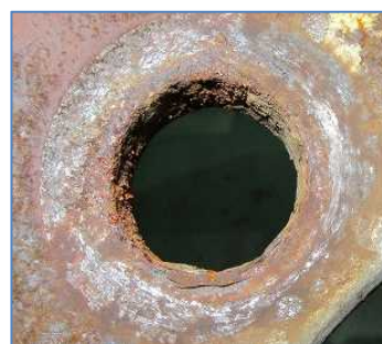
著しいさびによる ディスク・ホイールの損傷
