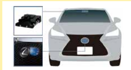
カメラ・ミリ波レーダー複合型 (レクサスHPより)
