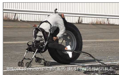
大型車の車輪が人に衝突した時の模擬動画
